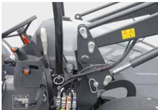
Погрузчик и трактор надежно соединены между собой при помощи специальной въездной системы фиксации.
