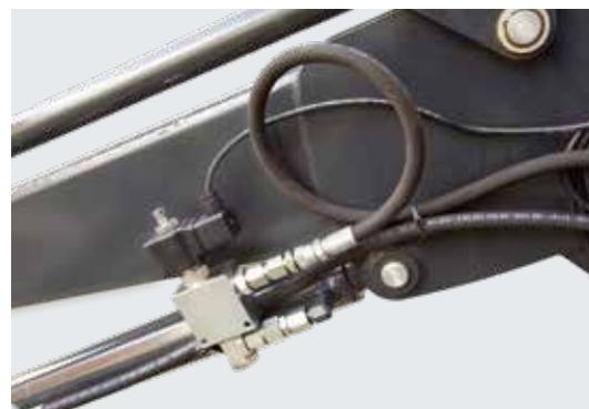
Предохраняет погрузчик от внезапного опускания в соответствии с требованиями EN 12525/A1.
