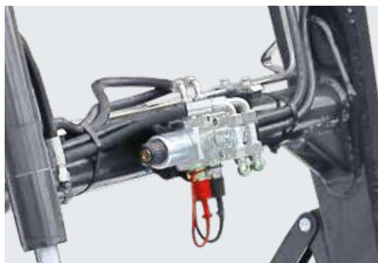
Для простого управления такими рабочими органами с гидроприводом, как ковшовой экскаватор, верхний захват, ковш с захватом, рейферные вилы и трелевочный захват.
