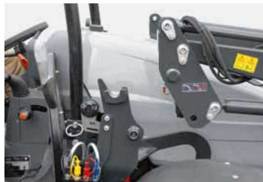
Чтобы снять погрузчик, требуется всего несколько движений. При помощи устройства управления рама выводится из монтажного элемента и отсоединяется гидравлика.
