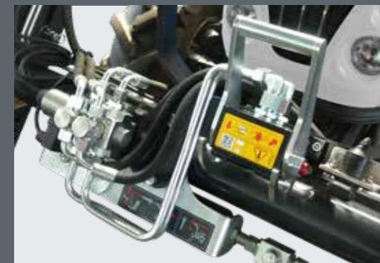
Tool-Fix компл. для легкого подсоединения гидравлических инструментов.
